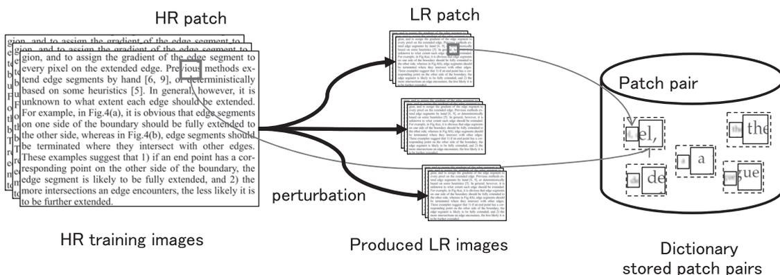
Fig. 1 Dictionary construction phase.
